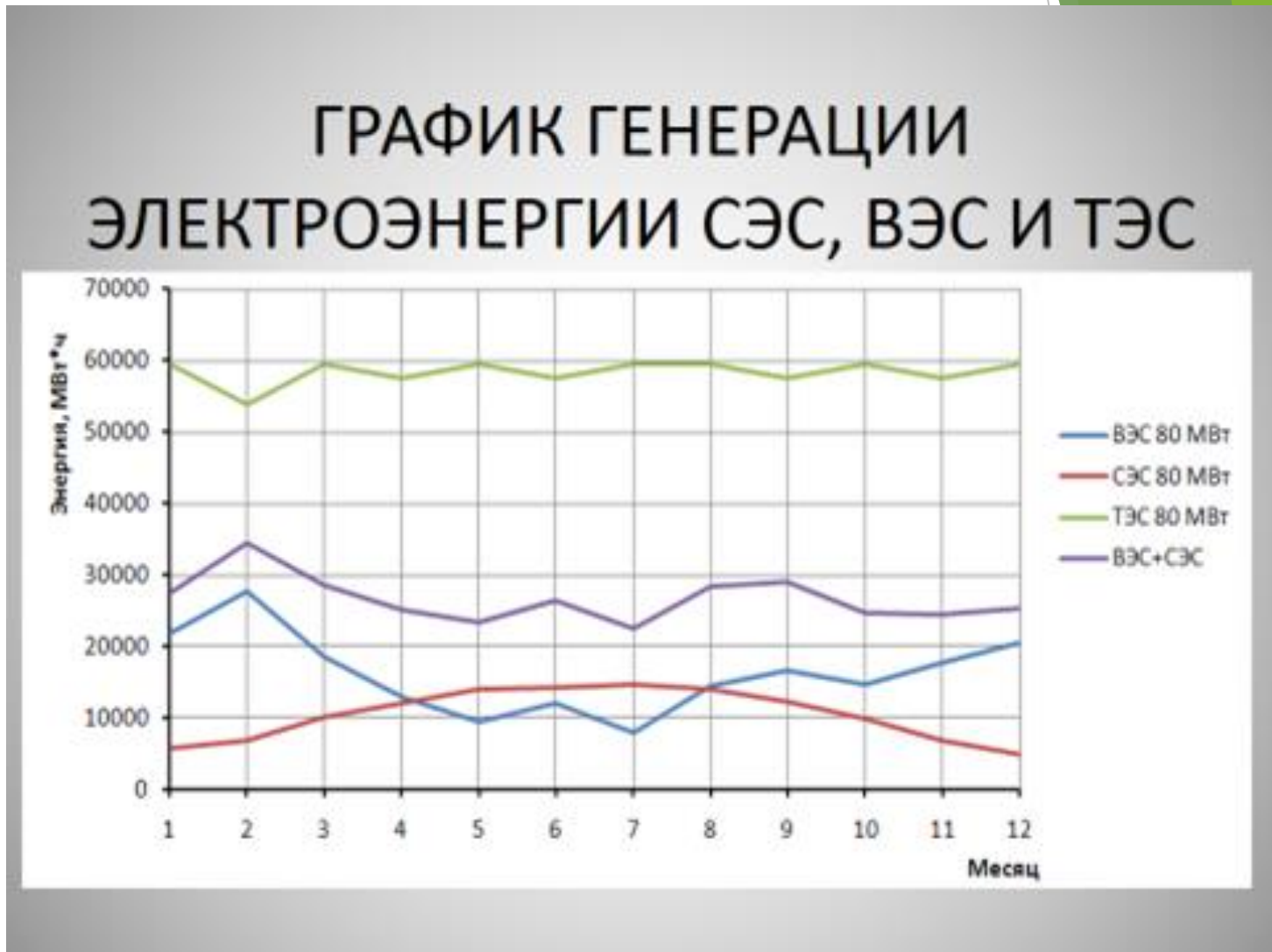
Рис. 2. График генерации электроэнергии СЭС, ВЭС и ТЭС.
