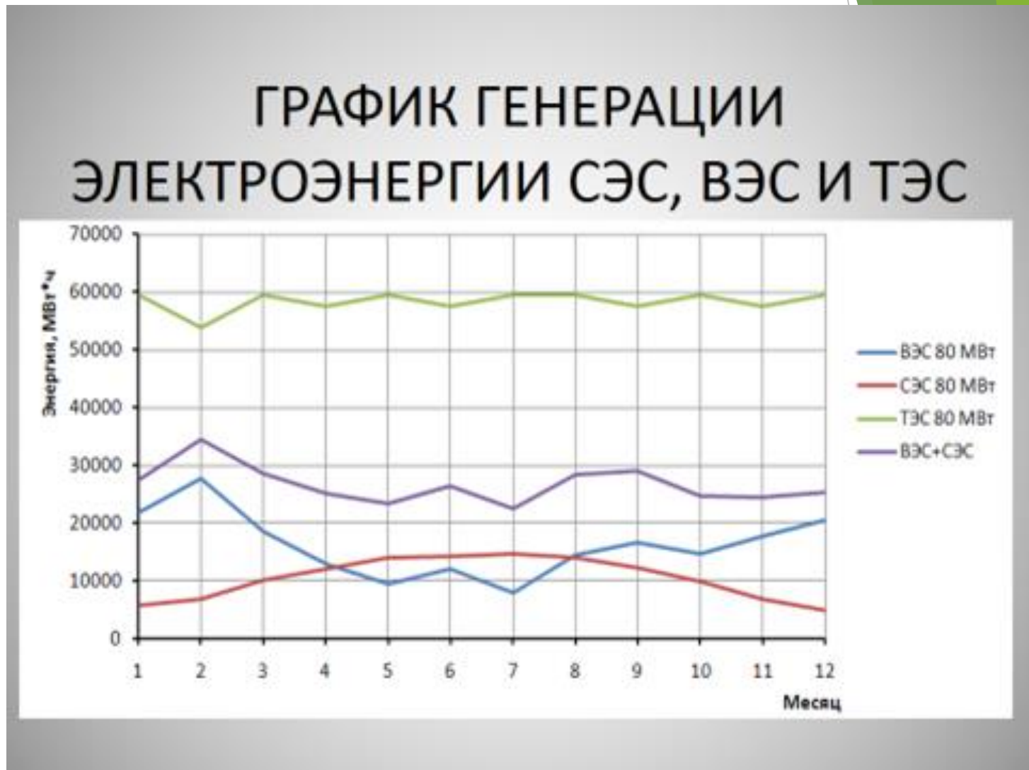
Рис. 2. График генерации электроэнергии СЭС, ВЭС и ТЭС.
