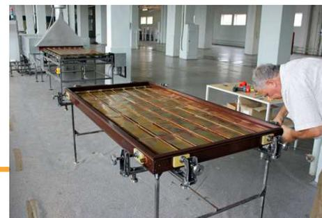
Абсорбер помещается в корпус из алюминиевого сплава и закрывается задней крышкой
