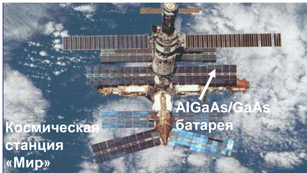
КС «Мир» с гетероструктурной солнечной батареей, изготовленной в НПП «Квант» по технологии ФТИ им.А.Ф.Иоффе
